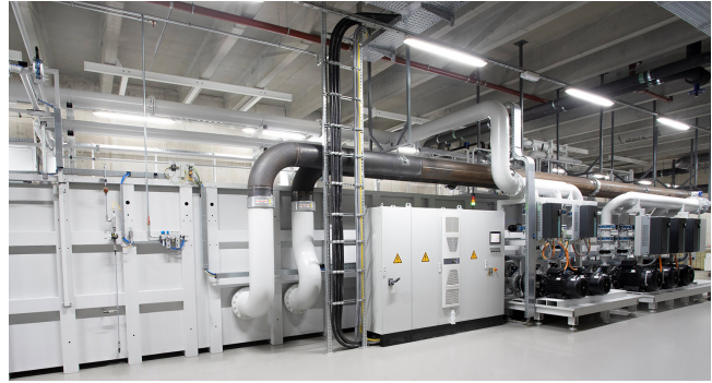
3 Überzeugt durch hohe Schleifölqualität, konstante Temperatur und moderate Kosten: Die Knoll-Zentralanlage für die Aufbereitung von zukünftig bis zu 12000 l/min © Mapal Group
